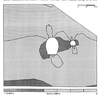
Bild 1. Minimale Hauptspannungen im Gebirge infolge des Kavernenausbruchs.
