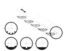
Bild 4. Fischdurchlass. Rohrströmung mit freiem Spiegel, durch Querschwellen verlangsamt
