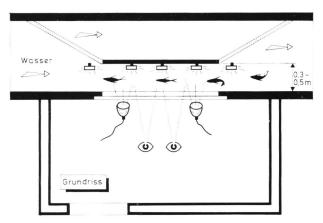
Bild 9. Visuelle Fischzählung durch eine seitlich am Fischpass angebrachte Glasplatte (nach *Travade* 1990).
