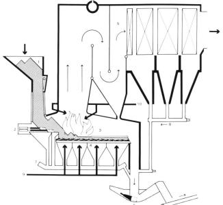
Figure 2. Coupe à travers du four avec la chaudière et l'échangeur de chaleur. 1 trémie, clapet d'obturation et puits de chargement; 2 dispositif de chargement; 3 chambre de combustion; 4 grille d'incinération; 5 chaudière à vapeur; 6 extracteur à mâchefers; 7 régulation des fines sous grille; 8 transport de cendre; 9 air de combustion primaire; 10 air de combustion secondaire.
