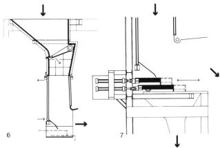
Figure 6. Trémie et puits de chargement. La trémie – dont la forme étudiée permet d'éviter toute formation de «pont» d'ordures – le clapet d'obturation et le puits de chargement forment l'unité de chargement du four. Le clapet d'obturation est pourvu sur la surface supérieure de tôles d'usure, et sa face inférieure est revêtue de masse réfractaire. Il est commandé par cylindre hydraulique. Le puits de chargement est à double manteau refroidi à l'eau.
