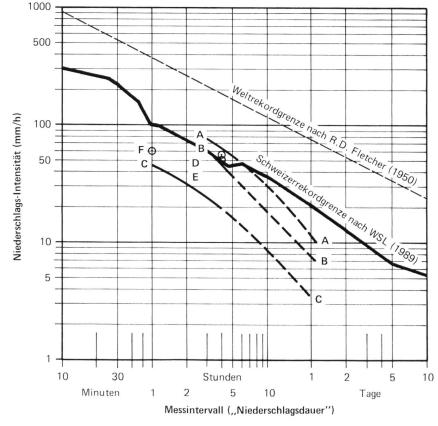
Bild 4. Niederschlagsintensitätsdiagramm von schweizerischen Niederschlagsrekorden der Untersuchungsperiode 1864–1989 [Geiger et al., 1991]. Darin eingezeichnet sind die Starkniederschläge des Sommerunwetters vom 29. Juli 1990 sowie die Weltrekordgrenze nach Fletscher. Man beachte den im Gürbeoberlauf gemessenen Niederschlagsverlauf (A), der im Bereich von drei bis fünf Stunden einen neuen Schweizer Rekord darstellt.
