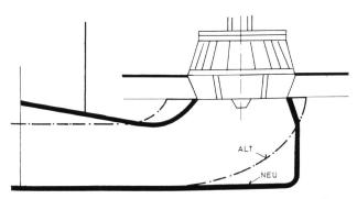
Saugrohrveränderung am Kraftwerk Ruppoldingen (Abbildung 158 aus «Saugrohre bei Flusskraftwerken»).
