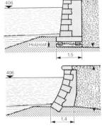
Bild 22. General-Guisan-Quai in Zürich bei hohem Wellengang (links) und zwei typische Querprofile für die Quaibauten 1882–1887 (Foto und Pläne Baugeschichtliches Archiv, Zürich).
