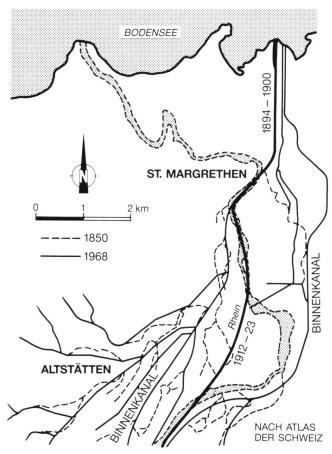
Bild 11. Endstrecke des Alpenrheins vor und nach den Korrektionen, mit einem Teil der Zuflüsse, die mittels der «Binnenkanäle» gefasst und abgeleitet werden.
