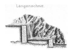
Bild 15. Ansicht und Längs(heute: Quer)schnitt der 1870 erstellten Sperre Nolla I (aus [19]).
