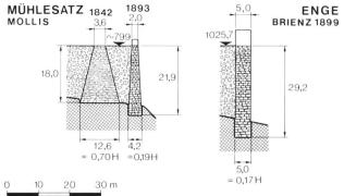
Bild 14. Querschnitte zweier grosser Wildbachsperren aus dem 19. Jahrhundert.
