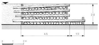
Bild 13. Querschnitt einer hölzernen Wildbachsperre von 1873 am Saxonnezbach, 17 km südwestlich von Sitten (nach [15]).
