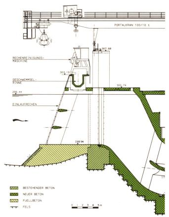
Bild 4. Neue Rechenanlage mit Rampen vor der Sohlenplatte.
