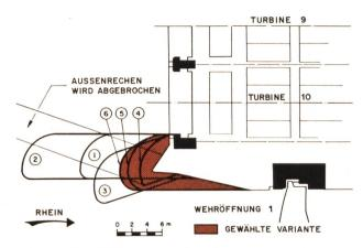
Bild 5. Trennpfeiler zwischen Turbine 10 und Wehröffnung 1.
