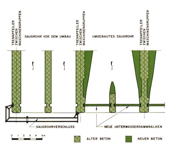
Bild 9. Saugrohrverschluss - Prinzip.
