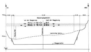
Bild 3. Typisches Baggerprofil.
