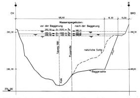
Bild 4. Typisches Baggerprofil beim «Murgerkolk».
