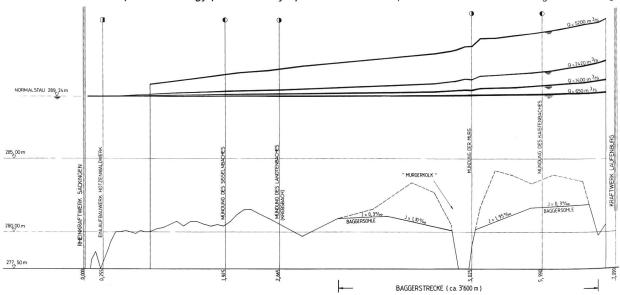
Bild 2. Überhöhtes Längenprofil der Rheinstrecke Säckingen-Laufenburg.
