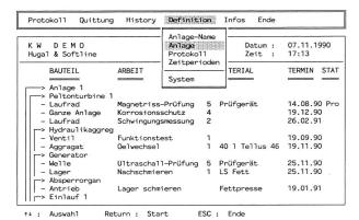
Bild 1. Eine übersichtliche Tabelle nach dem Programmstart zeigt dem Anwender die zu wartenden Anlageteile. Anlageteile, deren Wartung bereits angeordnet wurde, sind mit dem Status «Pro» vermerkt. Die Pfeile auf der linken Seite vermitteln die Zuordnung der Anlageteile zu den Baugrungen
