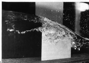
Bild 6. Seitliche Ansichten des Borda-Einlaufs. a) ohne und b) mit Hohlwirbelbildung.
