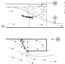
Bild 5. Definitionsskizze zum Borda-Einlauf. a) Längsschnitt, b) Grundriss.
