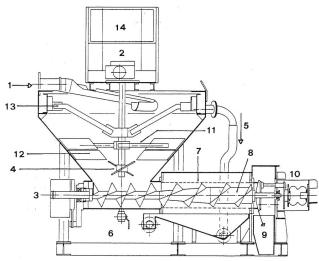
Bild 2. Schnitt durch die Tasster-Anlage zur Klärschlammbehandlung. 1 Zulauf geflockter Schlämme, 2 Motorreduziergetriebe, 3 Motorreduziergetriebe, 4 Kompaktierflügel, 5 Rückläufe, 6 Entleerung, 7 Gittersieb, 8 Extrudierschnecke, 9 Schlammaustritt, 10 Gegendruckvorrichtung, 11 Rührwerk, 12 Statischer Gegenflügel, 13 Überlaufvorrichtung mit Abstreifer und Sieb, 14 Passerelle.
