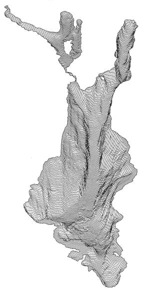
Gitternetzmodell des Bodenseebeckens aufgrund der Neuvermessung 1986–1989 (15fache Überhöhung). Schrägansicht aus etwa 165 km Höhe über dem Brennerpass mit Blickrichtung Nordwest.
