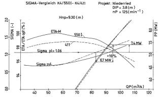
Bild 7. Vergleichsmessungen der alten Laufradform Typ 411 mit dem neuentwickelten Typ 550 I bestätigen die höheren Wirkungsgrade und die grösseren Überlastreserven der neuen Laufradform.
