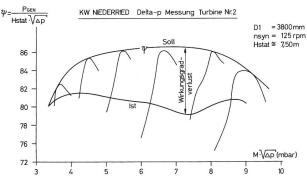
Bild 4. Gemessene Wirkungsgradverluste infolge von nicht korrektem Leitapparat/Laufrad-Zusammenhang.  $\Delta p$ -Messung an der Turbine 2 im Kraftwerk Niederried.
