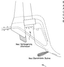
Bild 11. Massnahmen zur Verbesserung der Anströmung: überströmte Buhne im Oberwasser und Verlängerung des Einlaufkanals.
