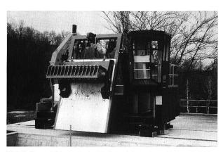
Bild 12. Neue, leistungsstarke Rechenreinigungsmaschine.
