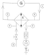
Bild 6. Schematische Darstellung des Messaufbaues im Generator-kühlsystem zur Kalorimetrie. G Generator, K Kühler, 1 Luftkreis, 2 Wasserkreis, T Temperaturmesstelle, 3 Schauglas, 4 Volumenstrommesser, 5 Absperrarmatur, Fliessrichtung.
