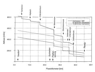
Bild 2. Abflusslängsschnitte der Maximalabflüsse entlang der Reuss für das rekonstruierte Ereignis 1987 und für das 10- und 50jährliche Hochwasser
