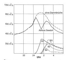
Bild 3. Abfluss der Reuss beim Pegel Seedorf am 24./25. August 1987 zwischen 20 Uhr und 6 Uhr. Eingezeichnet ist auch der Abfluss, der beobachtet worden wäre, wenn die Dämme nicht gebrochen wären. B1 bis B4 zeigen die Flüsse durch die aufgetretenen Breschen. B1 und B2 sind Ausflüsse, B3 und B4 Rückflüsse in den Kanal.
