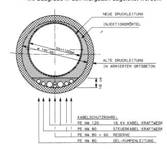
Bilder 5 und 6. Verlegung der Druckleitung im bestehenden Betonrohr (Relining).
