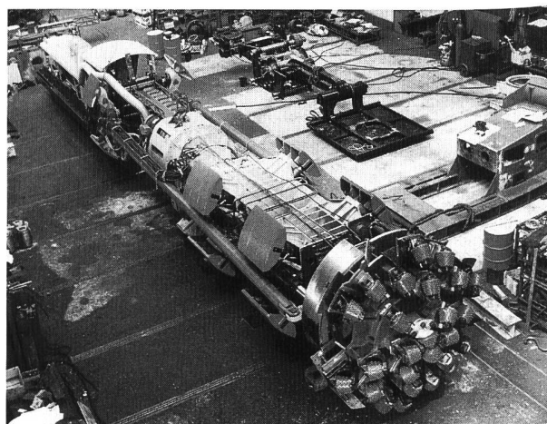
Bild 35. Werkstattaufnahme der Fräse für den Ausbruch des Druckschachtes Corbes des Kraftwerkes Emosson (Foto A. Wirth & Co. KG, Erkelenz/BRD).
