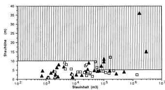
Bild 5. Stauinhalt (logarithmische Skala) im Vergleich zur Stauhöhe bei den gebauten und im Bau stehenden [A] und geplanten Becken [...]. Der schraffierte Bereich kennzeichnet die Becken, die der Talsperrenverordnung unterstehen.
