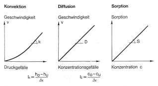
Bild 1. Für den Stofftransport im Boden massgebliche Einflüsse: Konvektion k, Diffusion D und Sorption S.
