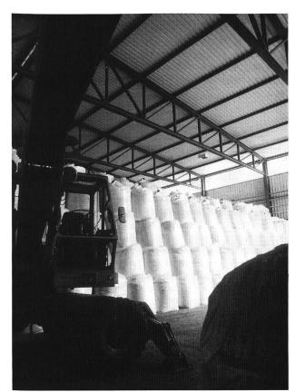
Bild 5. Lagerung der Filterstaubsäcke in einer Kehrichtverbrennungsanlage.
