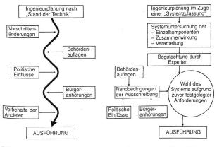
Bild 3. Planungsunterschiede für Deponien nach herkömmlicher Art (links) und bei Systemzulassung (rechts).
