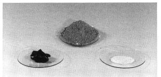
Bild 4. Links glasartige Schlacke, Mitte Kesselasche, Filterasche, rechts Schwermetallkonzentrat.
