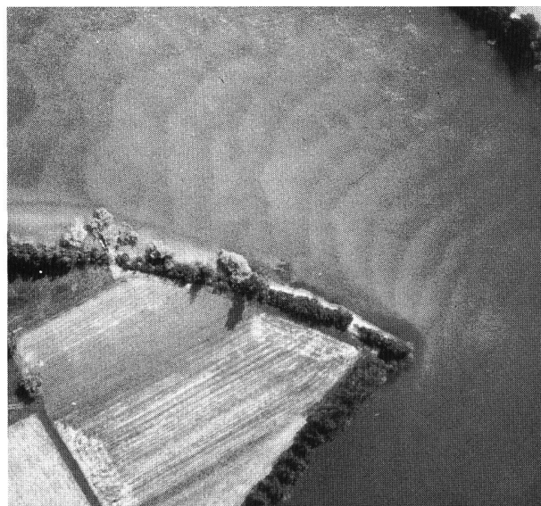
Bild 8. Sohlenformen (Dünen) der Aaresohle bei der Insel von Nennigkofen. Fließrichtung von links nach rechts.
