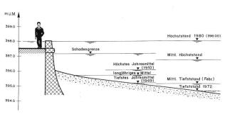
Bild 6. Wasserstandsschwankungen am Bodensee. Der Höchststand wurde am 3. September 1890 mit 398 mü. M. erreicht, die Schadengrenze liegt auf 397,14 mü. M. (Schweizer Horizont).
