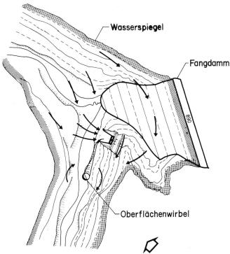
Bild 2. Modell Ait Chouarit, Grundrissskizze der Zuströmungsverhältnisse (Pfeile) vor dem eingestauten Einlauf des Umleitstollens. Die Aufnahmerichtung des Bildes 1 ist durch den grossen Pfeil (unten rechts) angege-
