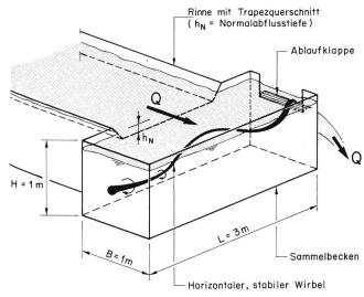
Bild 3. Unterwasserwirbel im Sammelbecken eines Labormodelles. Schematische Darstellung der Anlage.
