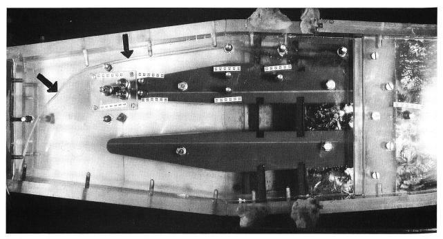
Bild 8. Modell San Roque. Wirbel in der rechten Schützenöffnung des Grundablasses, von unten aufgenommen (Pfeile). Rechts im Bild ist der Abfluss unterhalb der Schützenstelle sichtbar. (Linke und mittlere Schützen geschlossen, Strömung von links nach rechts.)
