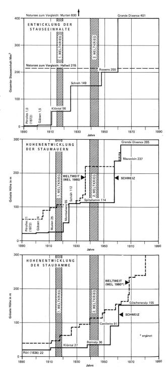
Bild 9. Entwicklung des Stauseeinhaltes in der Schweiz sowie der Höhen von Staumauern und -dämmen (mit internationalen Veraleichen).
