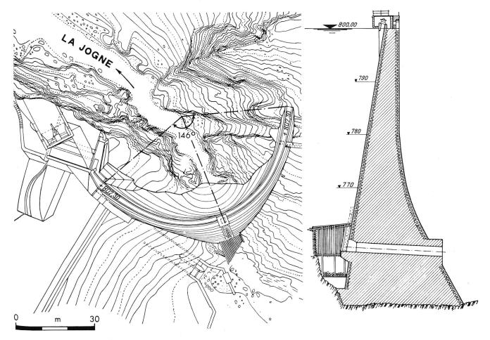
Bild 11. Höchster Querschnitt und Lageplan der Bogenstaumauer Montsalvens.
