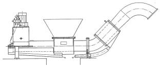
Bild 2. PC-Rechengut-Kolbenpresse mit Einfülltrichter, Entwässerungsund Transportrohr.
