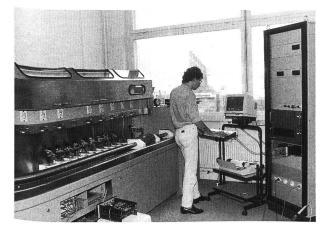
GWF-Mitarbeiter am Heisswasserzählerprüfstand.
