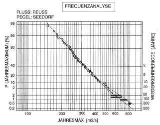
Bild 3. Frequenzdiagramm der Reuss bei Seedorf für den Spitzenabfluss mit erweiterter Datenbasis. Die rekonstruierten historischen Hochwasser sind als Bereiche eingetragen. Angegeben sind zwei denkbare Ausgleichsgeraden: Danach hat das Hochwasser 1987 eine Jährlichkeit zwischen 150 und 300 Jahren.
