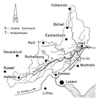
Bild 1. Das Einzugsgebiet des Rotbaches beträgt zusammen mit seinen Zuflüssen bei der Einmündung in die Reuss 77 km². Wichtige Zuflüsse sind: 1 Buzibach, 2 Gerbebach, 3 Augraben, 4 Waldibach, 5 Winkelbach.
