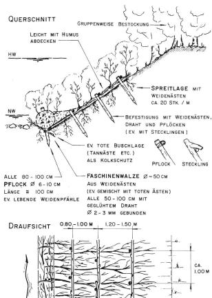
Bild 6. Die Ufer sind mit Lebendverbau gesichert. Zur Anwendung kamen Faschinenwalzen, Weidenwippen (2 Faschinenwalzen übereinander), Weidenspreitlagen und Steckhölzer.
