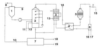
Bild 1. Funktionsschema einer Rauchgasreinigungsanlage System Steuler nach einer Abfallverbrennungsanlage mit Schwermetallkondensation.
