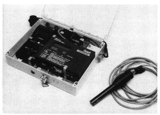
Bild 2. Das Abflussmessgerät mit Leitfähigkeitssonde.
