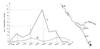
Bild 3. Spülung des Ausgleichsbeckens Bergün der Albula-Landwasser-Kraftwerke AG vom 18. August 1981. Spülwassermenge  $Q_{\rm S}=5~{\rm m}^3/{\rm s}$ . A Probenahmestelle 50 m unter dem Grundablasseinlauf; B Probenahmestelle bei der Kiesgewinnung unterhalb Bergüner Stein (etwa 3,5 km).
