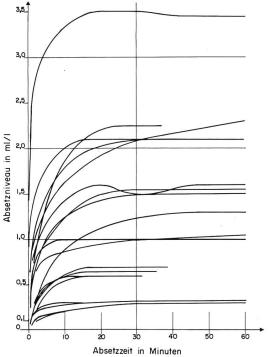
Bild 2. Entleerungen von Staubecken – Absetzproben.
