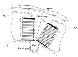
Bild 3. Luftführungskanal in der Pollücke unter den Polspulen für die Zufuhr kalter Luft an die Maschinenmitte.
