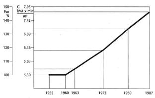
Bild 1. Die Ausnutzung von Wasserkraftgeneratoren im Leistungsbereich 25 bis 60 MVA bei Drehzahlen von 600 und 750 1/min und einer Nennspannung von 10 kV zwischen 1955 und 1987.
