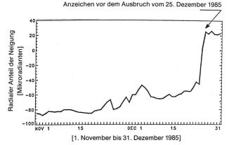
Bild 2. Ankündigung einer Eruption am Vulkan Ätna. Die schwere Eruption vom 25. Dezember 1985 wurde angekündigt durch einen starken radialen Neigungsanstieg von etwa 60 Mikroradianten. Etwa eineinhalb Stunden vor dem Ausbruch blähte sich der Vulkan deutlich auf und entspannte sich 20 Minuten vor der Eruption [Nunnari, Romano, 1985].
