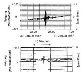
Mitteleuropa resultiert eine Neigungsänderung von etwa 0,1 Mikroradianten oder 0,1 Mikrometer pro Meter (Bild 4). Einen Vergleich der gebräuchlichen Neigungseinheiten zeigt Tabelle 1.
