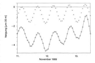
Bild 14. Erdgezeiten, registriert in der Albigna-Staumauer. Die X-Achse zeigt das Wochenende vom 11. bis 13. November 1989. Die untere Kurve (
