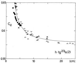
Bild 3.  $C_d$  in Abhängigkeit von h (cm) für verschiedene Öffnungswinkel tg  $(\alpha/2) = (\triangle) 1/2$ , ( $\blacktriangle$ ) 1/4 und  $(\nabla)$  1/8 nach Yarnall (1926), ( $\blacktriangledown$ ) 1/12 nach Reinhold (1933) und ( $\spadesuit$ ) 1/25 nach Grossi (1961).
