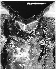
Bild 9. Überfallstrahlen bei relativ grossem Unterwassereinstau; a) S = 0.45, b) S = 0.61 und c) S = 0.75.
