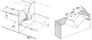
Bild 1. Schema eines Dreiecküberfalles – Bezeichnungen.
