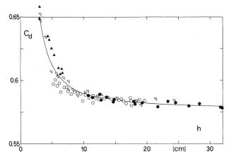
Bild 2. Überfallbeiwert  $C_d$  in Abhängigkeit von h (cm) für  $\alpha = 90^\circ$ ; (—) GI. (9). ( $\triangle$ ) Barr (1910), ( $\blacksquare$ ) Yarnall (1926), ( $\nabla$ ) Boucher (1937), ( $\blacktriangle$ ) Blaisdell (1939), ( $\bigcirc$ ) Heyndrickx (1948).
