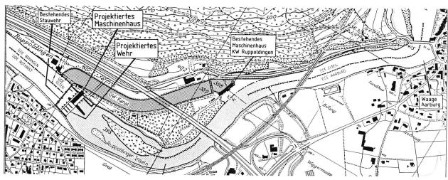
Bild 1. Generelles Vorprojekt für den Neubau des Kraftwerks Ruppoldingen. Situation.
