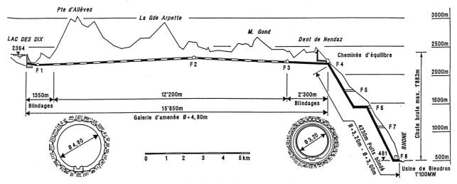
Bild 3. Längenprofil mit Druckstollen, Wasserschloss, Druckschacht und Zentrale Bieudron. Ebenfalls angegeben sind zwei Profiltypen für Druckstollen (links) und Druckschacht (rechts).
