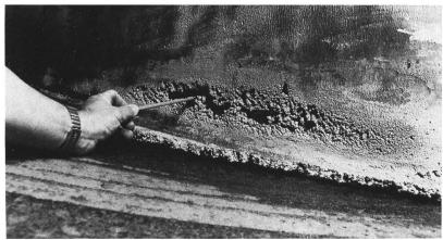
Bild 7.3-7. Kaplan-Laufradschaufel mit stark kavitierender Strömung.
