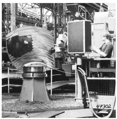
Bild 8.1–3. Fräsen der hydraulischen Form einer Laufradschaufel auf Fünfkoordinaten-Fräswerk. Nach dem gleichen Programm werden auch die Schaufeln für die Modellturbine bearbeitet.
