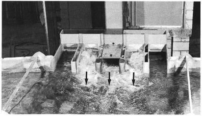
Bild 7.2–10. Seitenansicht der beiden Entlastungsorgane in Betrieb im Falle der vorgeschlagenen Lösung und bei hohem Aarewasserstand. Es ist kein Rückstau auf die Segmentschütze festzustellen.
