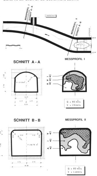
Bild 7.2–14. Längsschnitt durch die Zuleitung zur Rohrturbine und Angaben über die Querschnittabmessungen sowie über die gemessenen Geschwindigkeitsverteilungen beim Turbinenbetrieb von 80 m³/s.
