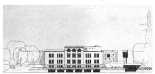
Bild 14–2. Fassadenansicht einer Umbauvariante, links die alte Zentrale rechts der Zwischentrakt und das neue Maschinenhaus.
