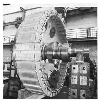
Bild 8.2–1. Werkansicht des Generator-Polrades. Zu erkennen sind die 40 Pole, die Polverbindungen sowie die Auflageflächen des kombinierten Radial- und Führungslagers.
