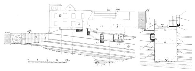
Bild 6–2. Längsschnitt durch die Baugrube. 1 Zulaufstollen, 2 Kabelgang, 3 Aussentrafo, 4 alte Zentrale, 5 Fangedamm, I1 I2 I3: Inklinometerbohrungen, A1 A2 B1 B2: Messquerschnitte der Distometermessungen.
