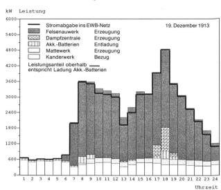
Bild 4–2. Leistungsdiagramm Elektrizitätswerk der Stadt Bern vom 19. Dezember 1913 *nach* Betriebsaufnahme des Kraftwerks Felsenau.
