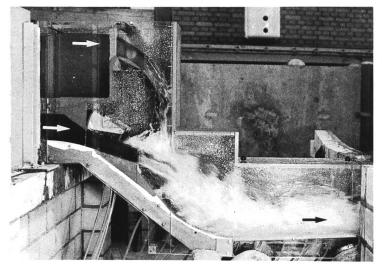
Bild 7.2–5. Entlastung von 80 m³/s im Grundablasskanal ohne Einbauten. Beide Entlastungsorgane sind in Betrieb, und das Wasser schiesst fast ohne Energieumwandlung durch den Kanal.
