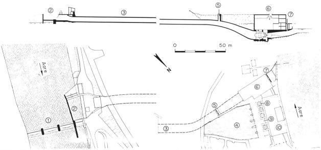
Bild 5-1. Längsschnitt durch die Analge Felsenau oben. Unten links Grundriss Wehr und Wasserfassung, rechts Zentrale Felsenau. 1 Wehr, 2 Wasserfassung, 3 Druckstollen, 4 Vorbecken, 5 Einlaufschütz, 6 neue Maschinenhalle, 7 Auslaufschütz, 8 Überfallschächte, 9 Schwallentlastung: Klappe und Segmentschütz, 10 alte Maschinenhalle.
