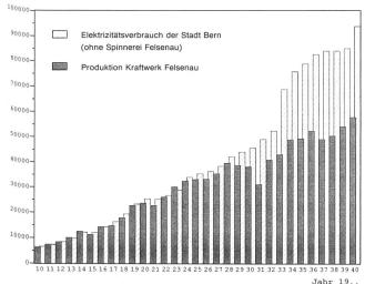
Bild 4–3. Elektrizitätsverbrauch der Stadt Bern und Produktion des Kraftwerks Felsenau 1910 bis 1940.
