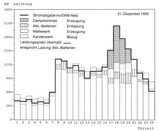
Bild 4–1. Leistungsdiagramm Elektrizitätswerk der Stadt Bern vom 21. Dezember 1906 vor Betriebsaufnahme des Kraftwerks Felsenau.
