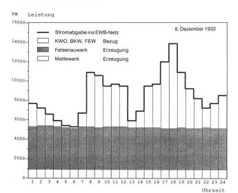
Bild 4–4. Leistungsdiagramm Elektrizitätswerk der Stadt Bern vom 8. Dezember 1932; das Kraftwerk Felsenau dient als Grundlastwerk.
