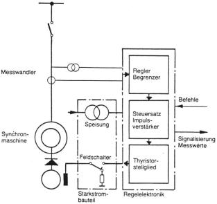
Bild 11-1. Aufbau der Erregung für das Kraftwerk Felsenau.
