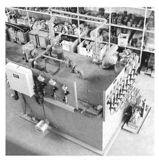
Bild 8.2-5. Werkansicht des Schmier-Öltanks mit 3000 I Inhalt. Daran angebaut sind der Automatikfilter (links hinten), die Pumpenmotoren (links oben), der Klemmenkasten (links vorne), die Stillstandsheizung (links unten), der Ölnebelabsaugventilator (rechts oben), die Hochdruckpumpe (rechts unten).
