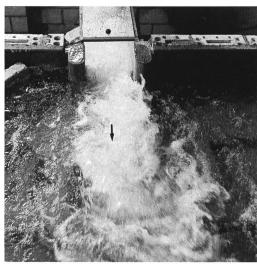
Bild 7.2–6. Entlastung von 80  $\rm m^3/s$  im Grundablasskanal ohne Einbauten. Das Wasser kommt mit grosser Geschwindigkeit aus dem Kanal und erzeugt eine starke Störung quer zur Aare.
