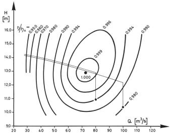
Bild 7.3-6. Wirkungsgrad-Muscheldiagramm für den gesamten Fallhöhen- und Wasserstrombereich.
