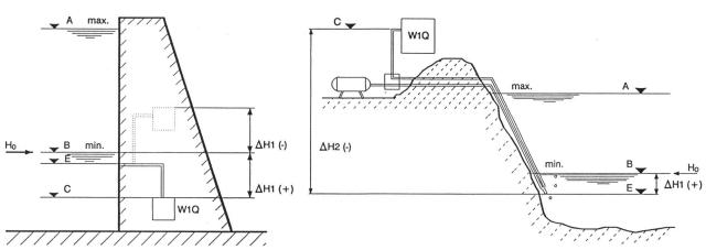
Bild 3. Prinzip der hydrostatischen Wasserstandsmessung.
