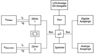
Bild 2. Blockschema der Füllstandsmesseinrichtung, bestehend aus Druckaufnehmer P<sub>Niveau</sub> und P<sub>Barometer</sub> sowie der zugehörigen intelligenten Auswerteeinheit
