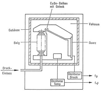
Bild 1. Aufbauprinzip des Quarzdruckaufnehmers.
