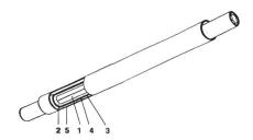
Bild 3. Ozonerzeugerelement. 1 innere Metallelektrode, 2 Gasspalt, 3 Gasrohr, 4 Gasspalt, 5 Aussenelektrode.
