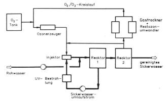
Bild 10. Verfahrensbild einer Sickerwasserozonung.
