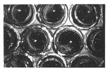
Bild 2. Bündel herkömmlicher Ozonerzeugungselemente.
