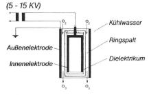
Bild 1. Prinzip eines einfach wirkenden Röhrenozonerzeugers.
