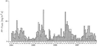
Bild 1. Saisonale Variation der Sedimentation im Sempachersee. Angaben in g $\,m^{-2} Tag^{-1}$  für das Trockengewicht des sedimentierten Materials (Partikelfluss) und den partikulären organischen Kohlenstoff (POC) und in mg $\,m^{-2} Tag^{-1}$  für den partikulären Phosphor (PP). Punktierte Balken bezeichnen den Stofffluss in 20 m Tiefe und schraffierte Balken denjenigen in 80 m.
