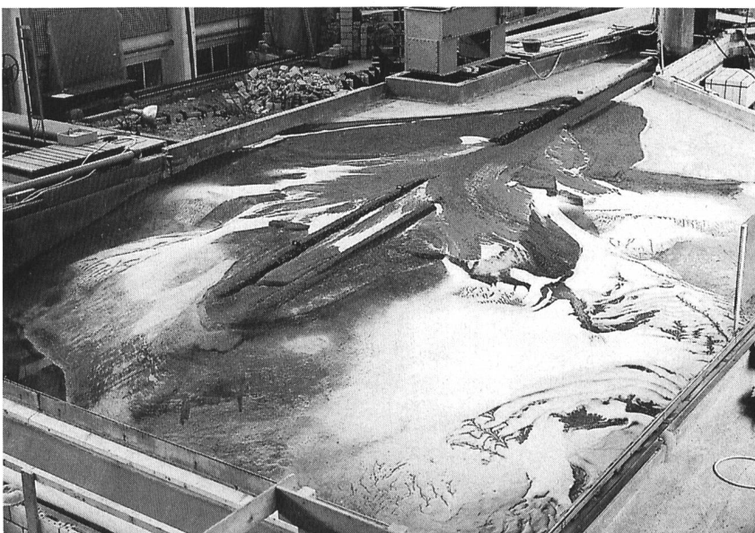
Figure 3. Etude du dépôt de suspensions (simulées par un matériau fin synthétique de couleur blanche) lors de la formation d'un delta lacustre.
