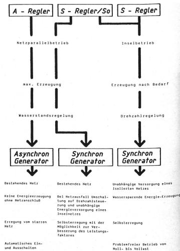
Bild 7. Die verschiedenen Reglerarten und ihre Anwendung. A-Regler für Asynchron-Generatoren, S-Regler/So für Synchrongeneratoren im Netzparallelbetrieb oder im Inselbetrieb, S-Regler für Inselbetrieb.
