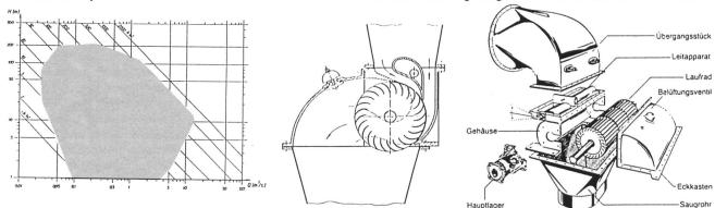
Bild 1, links. Einsatzbereich der Durchströmturbinen. Bild 2, Mitte. Schnitt durch eine Ossberger-Durchströmturbine. Bild 3, rechts. Aufbau der zweizelligen Durchströmturbine.
