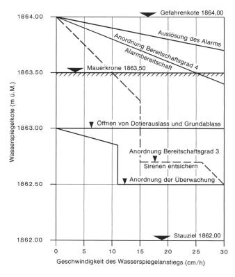
Bild 2. Oben: Tabelle zur Ermittlung der Wasserspiegelkoten und der Geschwindigkeit des Wasserspiegelanstiegs. Unten: Formular für die Notfallstrategie im Hochwasserfall für das Beispiel des Staubeckens Zervreila.
