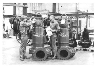
Bild 2. Die vier 90-kW-Tauchpumpen (Typ CS 3355) des schwedischen Pumpenherstellers Flygt mussten, paarweise in den 25 m unter Strasseniveau liegenden Abwassersumpf abgesenkt, einen Volumenstrom von 1600 I/s bewältigen. Von der Bestellung bis zum Einbau vor Ort vergingen nur zehn Arbeitstage.
