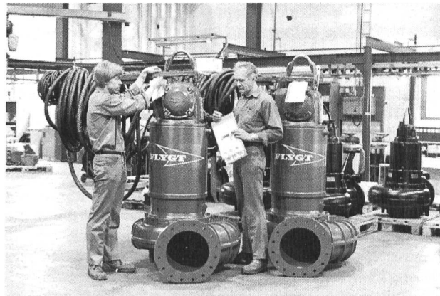
Bild 2. Die vier 90-kW-Tauchpumpen (Typ CS 3355) des schwedischen Pumpenherstellers Flygt mussten, paarweise in den 25 m unter Strassenniveau liegenden Abwassersumpf abgesenkt, einen Volumenstrom von 1600 l/s bewältigen. Von der Bestellung bis zum Einbau vor Ort vergingen nur zehn Arbeitstage.
