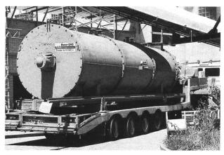
Bild 5. Anlieferung des Schlammtrockners der ersten Stufe für eine Trokkensubstanz von 45 bis 55% für die neue Klärschlamm-Trocknungsanlage.
