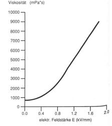
Bild 2, rechts. Darstellung der Viskositätsveränderung unter dem Einfluss von veränderter Feldstärke.
