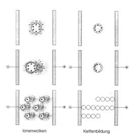
Bild 1, links. Die Viskosität einer «elektroviskosen Flüssigkeit» in Abhängigkeit von der elektrischen Feldstärke.
