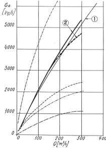
Bild 12. Geschiebetransportkapazität des Stollens und der Rovana. 1 Geschiebetransportkapazität des Stollens, 2 Geschiebetransportkapazität der Rovana.
