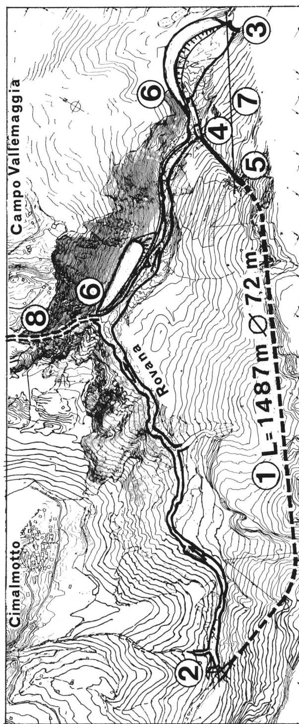
Bild 9. Projekt für einen Umleitstollen der Rovana im Bereich der Rutschung von Campo Vallemaggia. 1 Umleitstollen, 2 Einlaufbauwerk, 3 Geschieberückhaltesperre Secada, 4 Talseitiges Tosbecken, 5 Ostportal des Umleitstollens, 6 Materialdeponien, 7 Provisorische Bauseilbahn, 8 Verbauung des Riale S. Giovanni.
