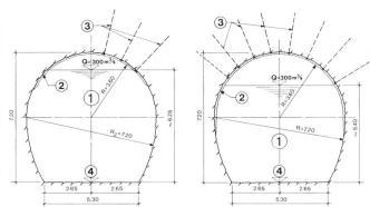
Bild 10. Zwei Stollenprofile. 1 Stollenprofil 43,7 m², 2 Kopfschutz aus Spritzbeton 3 bis 10 cm, 3 Felsanker, 4 Unverkleidete Stollensohle.
