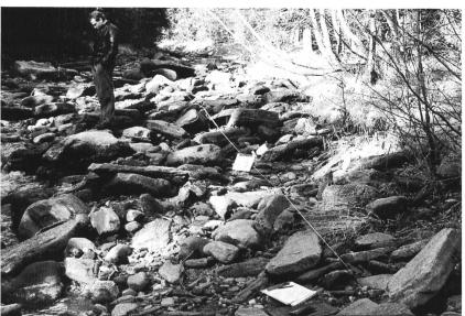
Bild 11. Erstellen einer Linienprobe zur Erfassung der Grobkornkomponente der Deckschicht. Flussabschnitt der Rovana oberhalb des vorgesehenen Einlaufbauwerkes des Umleitstollens.
