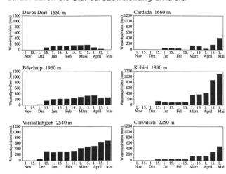
Bild 2. Schneedeckenverlauf im Winter 1988/89 (Wasseräquivalent).
