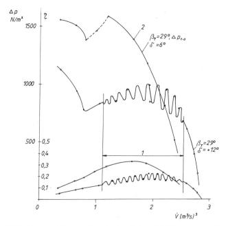
Bild 6. Messergebnisse an einem Axialventilator mit richtiger oder um 12° falscher Schaufelverwindung. Letzteres ist einem Weglassen der Schaufelverwindung gleichzusetzen.
