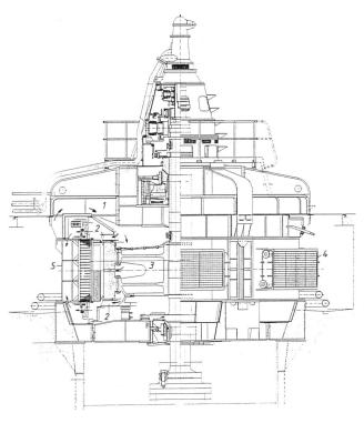
Bild 2. Dreiphasen-Generator, 21400 kVA; 10500 V;  $\cos \varphi = 0.7$ ; 50 Hz; 214/666 min<sup>-1</sup>; Baujahr 1954.
