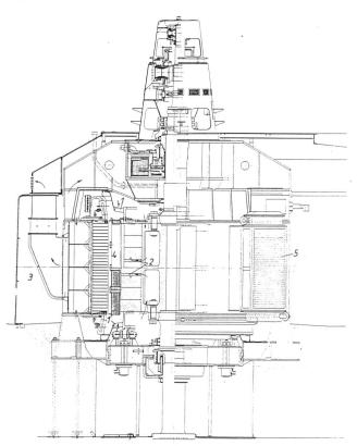
Bild 3. Dreiphasen-Generator, 64000 kVA; 10500 V;  $cos\phi = 0.9$ ; 50 Hz; 500/870 min $^{-1}$ ; Baujahr 1960.
