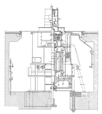
Bild 8. Dreiphasen-Eigenbedarfsgenerator, 850 kVA; 400 V;  $\cos \varphi = 0.7$ ;  $n = 750 \text{ min}^{-1}$ , Aufstellungshöhe H = 1315 m ü.NN.
