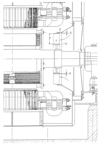
Bild 5. Generatorausschnitt mit Axialventilator und falsch ausgebildeter äusserer Verschalung.
